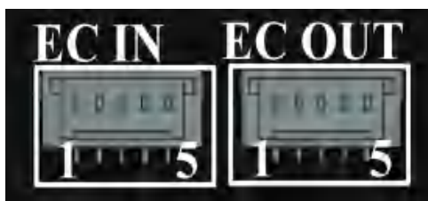
EtherCAT 版 100V 端子脚位示意
